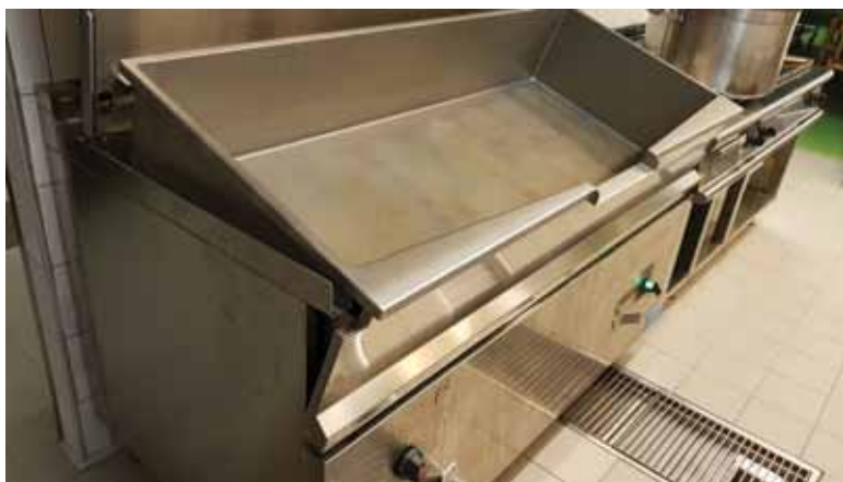
Prekucna ponev za peko, praženje in kuhanje. Takšno ime nosi zato, ker je možno s preprostim stikalom spreminjati njen nagib, kar omogoča lažje zajemanje hrane in čiščenje.
