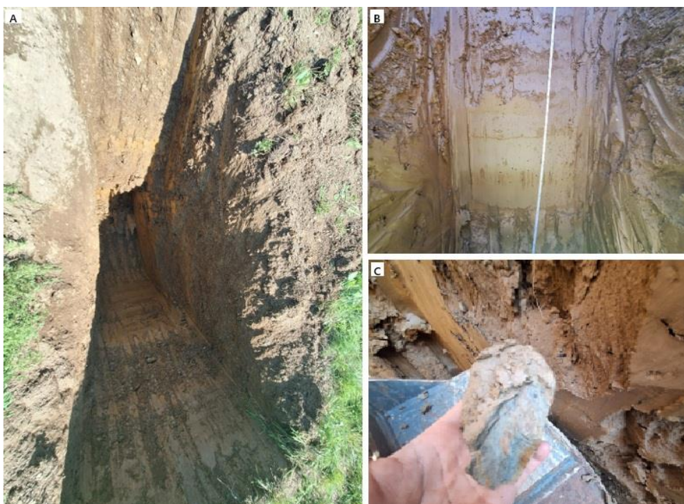
Slika 9: Sestava tal na lokaciji 4, A: celoten profil jaška, B: rjava glina in C: odlomki skrilavca.
