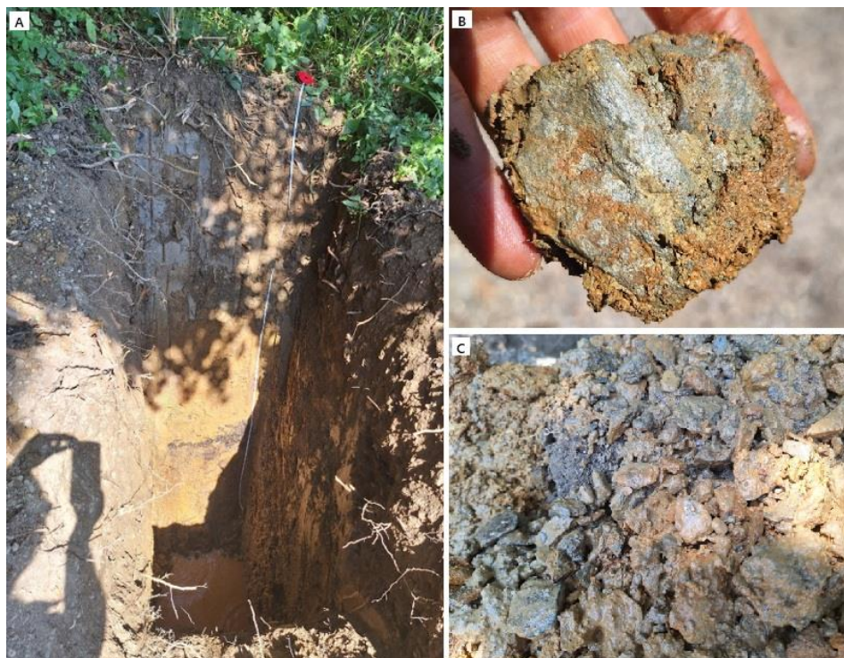
Slika 11: Sestava tal na lokaciji 4, A: celoten profil jaška, B: skrilavec in C: preperela podlaga.
