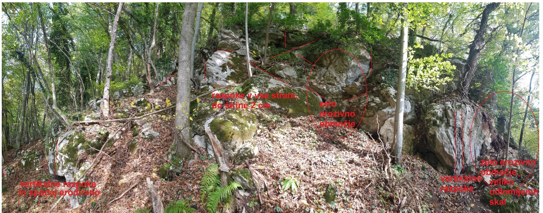
Slika 1: Skalni čok 1 z označenimi potencialno nevarnimi predeli.
