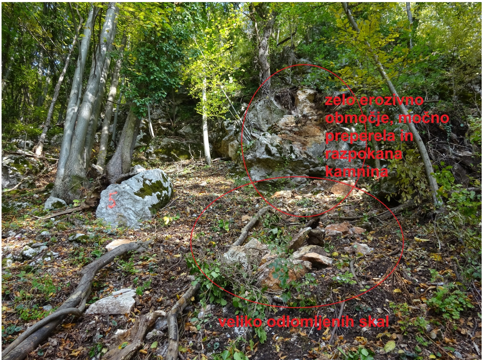
Slika 2: Fotografija zajeta iz vzhodnega dela skalnega čoka 1, z označenimi potencialno nevarnimi predeli.
